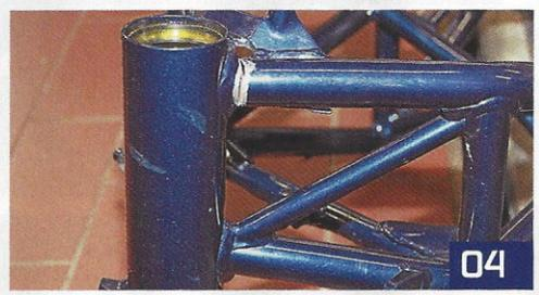
**01** Dieser Honda-Rahmen hat nur leichte Kratzer an der Seite (großes Bild) und einen verformten Steuerkopf **02** Rahmenriss an der unteren Quertraverse nach Auffahrunfall **03** Yamaha YZF-R6-Rahmen mit Rissen innen im Oberzug nach Sturz und hartem Aufprall **04** Reparabler Stahlgitterrohrrahmen einer Ducati Monster
