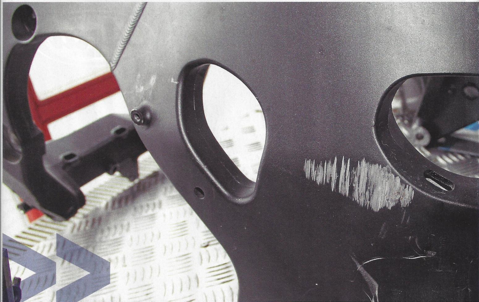
Selbst vermeintlich harmlose Unfälle können an modernen Rahmen ernsthafte Schäden mit gravierenden Folgen für die Fahrsicherheit hinterlassen. PS informierte sich bei einem Gutachter ganz genau.
